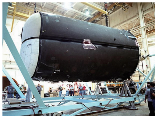
图2 X-33复合材料液氢贮箱
